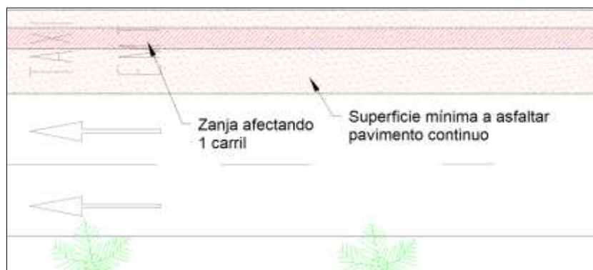
Figura 4. Afecció 1 carril. Superfície a reasfaltar.
