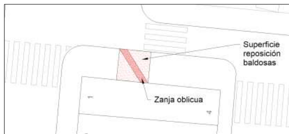
Figura 6. Superficie reposición baldosas en zanja oblicua.
