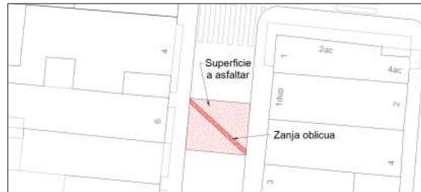
Figura 1. Afecció 1 carril. Superfície mínima a asfaltar.
