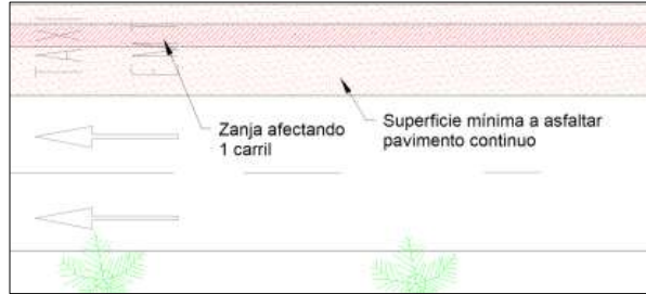
Figura 4. Afección 1 carril. Superficie a reasfaltar.
