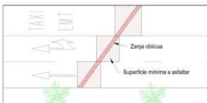
Figura 2. Afección varios carriles. Superficie mínima.
