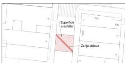
Figura 1. Afección 1 carril. Superficie mínima a asfaltar.
