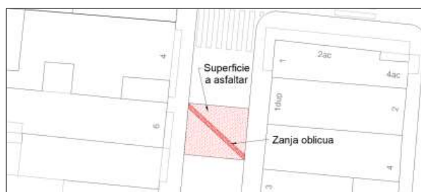
Figura 1. Afección 1 carril. Superficie mínima a asfaltar.
