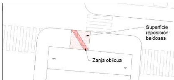
Figura 6. Superficie reposición baldosas en zanja oblicua.
