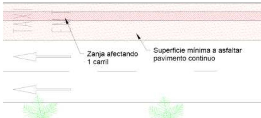
Figura 4. Afección 1 carril. Superficie a reasfaltar.
