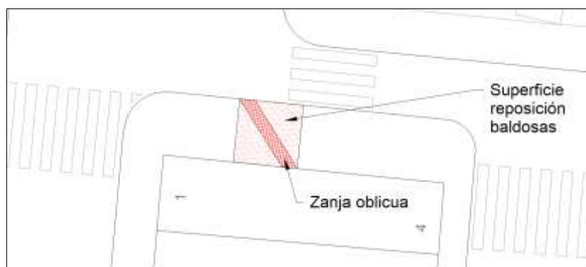
Figura 6. Superficie reposición baldosas en zanja oblicua.
