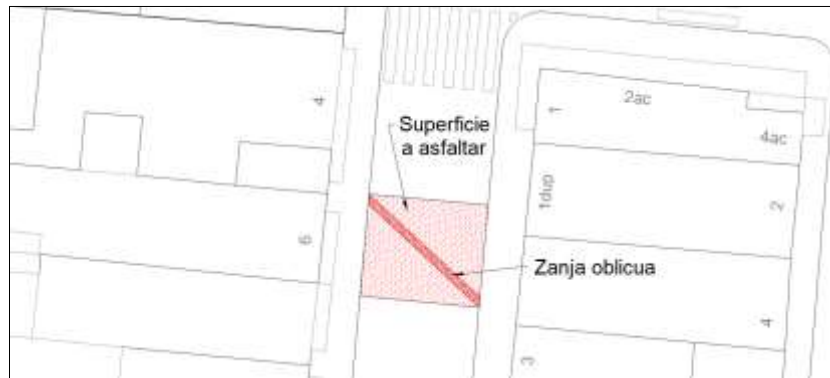
Figura 1. Afección 1 carril. Superficie mínima a asfaltar.
